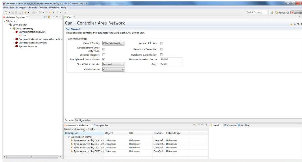
为了满足客户的不同项目需求，提高基础软件平台的扩展性，木牛基础软件平台实现了各个模块可配置性，并且实现了配置工具。客户可根据不同需求，在配置工具上完成各个模块的配置工作，可生成配置代码文件，将生成的配置文件集成到工程中即可。
