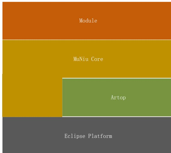
木牛基础软件平台的配置工具是基于 Eclipse 平台，并基于 ARTOP 架构，实现 AUTOSAR 模型和 ARXML 的解析。MuNiu Core 完成配置工具的 UI 界面，在 MuNiu Core 之上的 Module，实现 AUTOSAR 各个模块的配置。配置完成后，可生成各个模块的配置代码。
